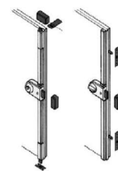
Stangenschloss/Aufsatzschloss mit Mehrpunktverriegelung
